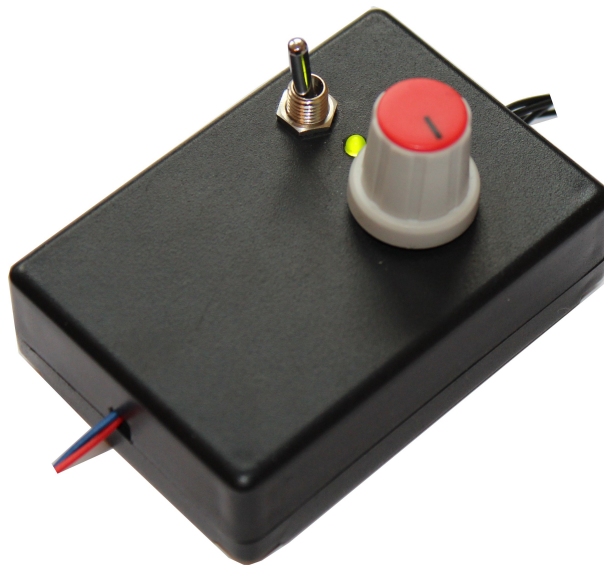
Abbildung 2: Der Generator montiert im optional erhältlichen Gehäuse
